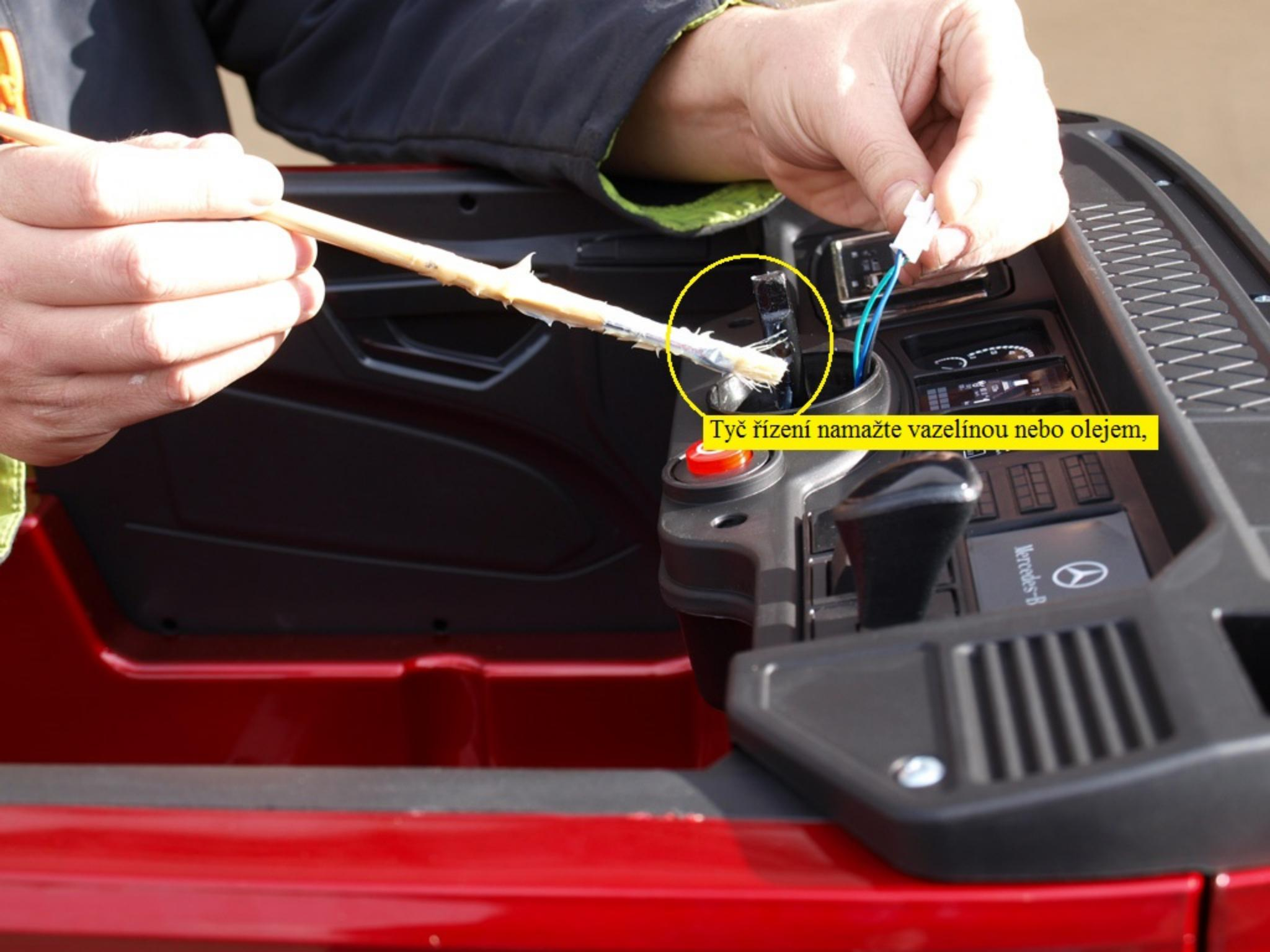
Tyč řízení namažte vazelinou nebo olejem,
